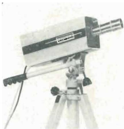
I laboratori DUMONT, Divisione della FAIRCHILD CAMERA INSTRUMENTS Co., hanno messo a punto una telecamera per uso in circuiti di TV industriale, tipo TC350. Tale nuova telecamera, interamente transistorizzata, ha risoluzione orizzontale di 775 righe e può essere completamente comandata a distanza.
